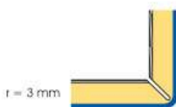
90° ye kadar kıvrıma için açılacak V-Kanal Groove (V-shaped) for edges up to 90°
