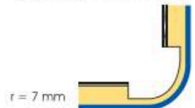
180° ye kadar kıvrıma için açılacak Dik Kanal Rectangular groove for edges up to 180° depending on panel thickness
